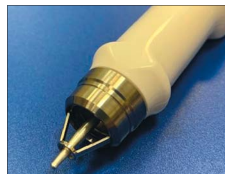
Рис. 3. Шток тонометра ТВГД-02, осуществляющий измерение ВГД Fig. 3. The TVGD-02 tonometer rod provides IOP-measurement
