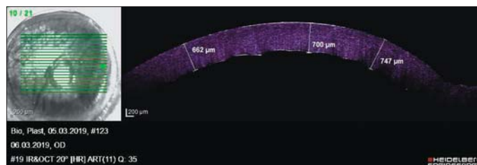
Рис. 3. Толщина биофлекса после его инкубации (регидратации) в физиологическом растворе в течение 3 ч
